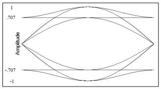
Figure A-16. FQPSK Wavelet Eye Diagram
