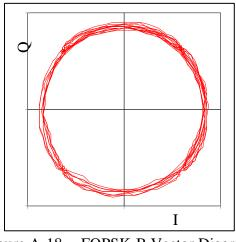
Figure A-18. FQPSK-B Vector Diagram
