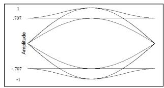
Figure A-16. FQPSK Wavelet Eye Diagram
